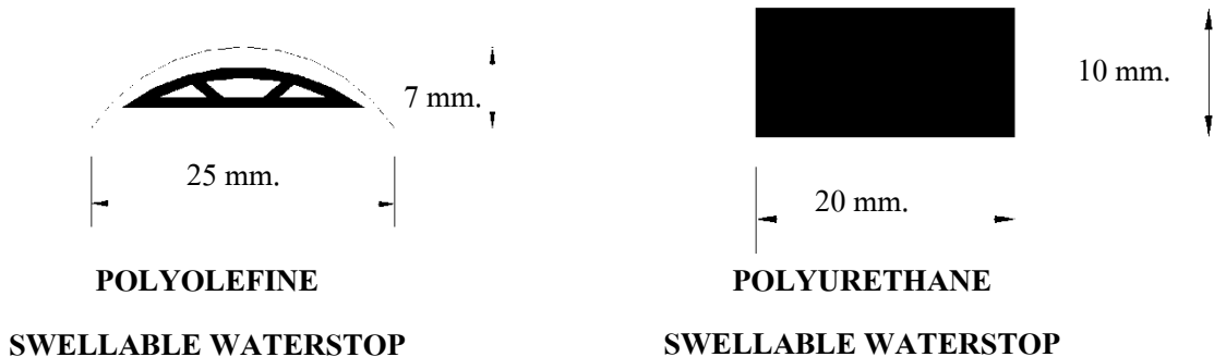
ตารางที่ 1 คุณสมบัติของแผ่นกันน้ำชนิด SWELLABLE WATERSTOP
